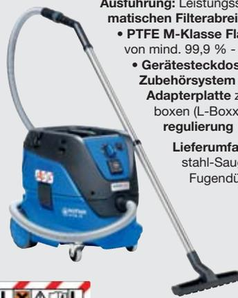
**Ausführung:** Leistungsstarker Industriesauger mit **vollautomatischem Filterabreinigungssystem InfiniClean™** • **PTFE M-Klasse Flachfilter** mit einem Abscheidegrad von mind. 99,9 % - **zertifiziert nach Staubklasse L** • **Gerätesteckdose** mit Einschaltautomatik • **Multifit-Zubehörsystem** garantiert hohe Flexibilität • **Optional: Adapterplatte** zur Aufnahme gängiger Werkzeugboxen (L-Boxx, TANOS-Systainer) • **Drehzahlregulierung**
