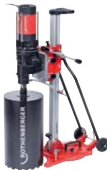
**Lieferumfang:** Bohrständler RODIACUT 250, Bohrmotor RODIADRILL 500, Werkzeugset, Befestigungs-Set Beton, Wasseranschlussschlauch, Kupferring 1.1/4" und Hammerbohrer SDS Plus 15x160 mm
